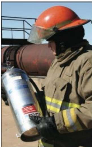
Figura 7.11a Confirme que el exterior del extintor no está dañado.
