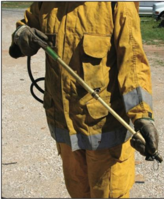
Figura 7.2a Un extintor con una bomba manual requiere que el operador aplique presión a la bomba para aumentar la presión en el contenedor.
