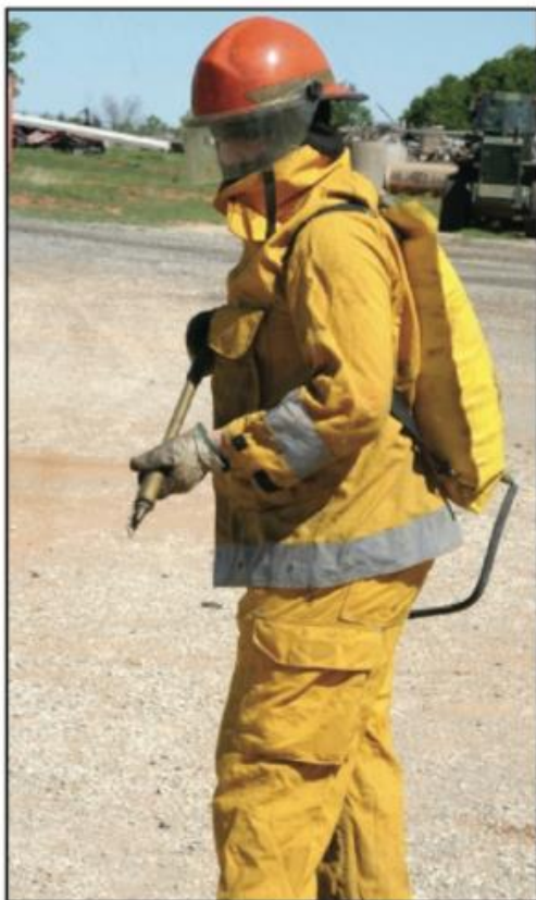
Figura 7.3 Un extintor de agua operado por una bomba puede usarse como una mochila y produce los mismos tipos de patrones de corriente que las boquillas de manguera.
