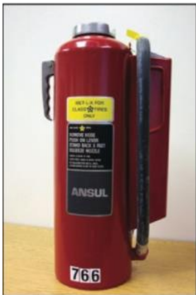
Figura 7.10 Los extintores de Clase D usan polvo seco para aislar el combustible
