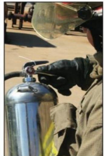
Figura 7.11d Un manómetro, si está presente, debe registrar una lectura dentro del rango operable.
